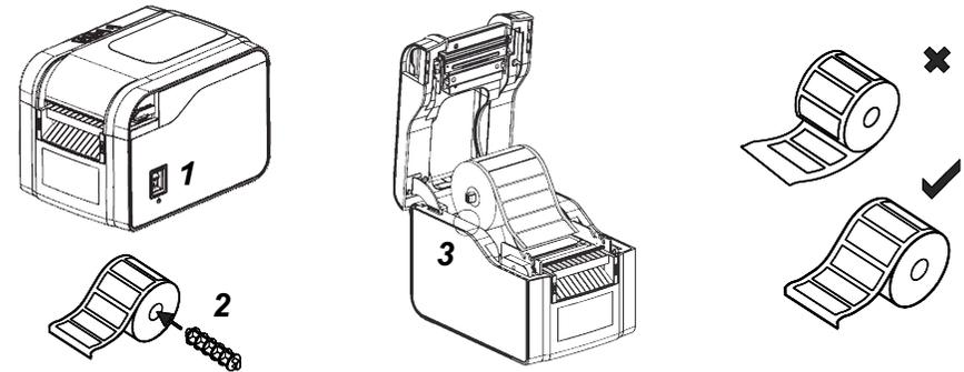
En caso de usar un rollo de papel (continuo o de etiqueta) menor a 80 milímetros de ancho, use las guías para centrarlo en el impresor. También tiene la opción de usar un porta rollo (no provisto en el equipo) para cuando el diámetro del mismo es mayor al que puede ir en el interior del impresor.
