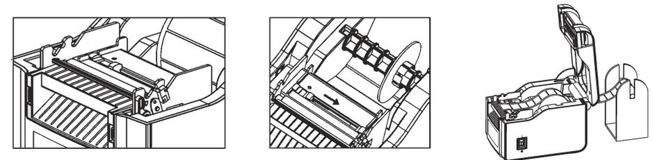
Tire hacia abajo de la palanca del rodillo despegable para desbloquearlo.
